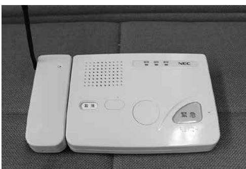
緊急通報装置
