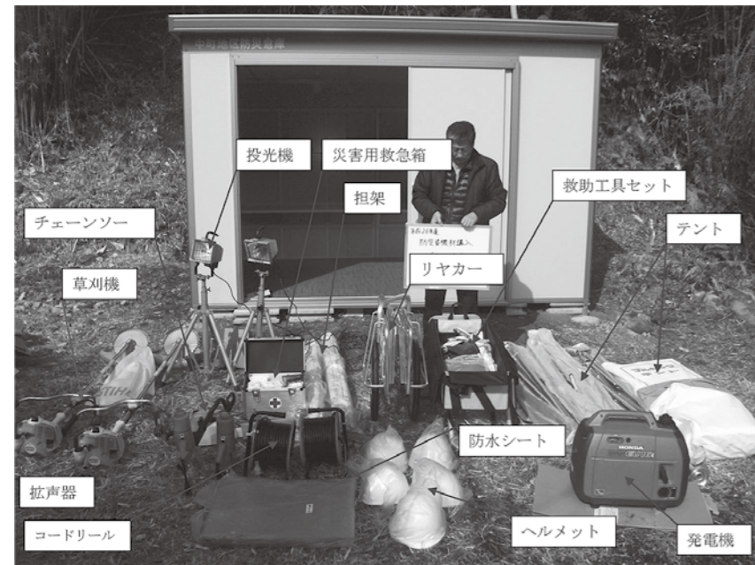
防災資機材の種類
